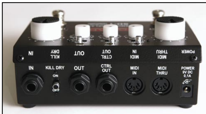
Panel tylny został szczelnie wypełniony gniazdami przyłączeniowymi, wśród których nie zabrakło złączy MIDI IN oraz wyjścia CTRL OUT służącego do sterowania efektem G LAB Dual Reverb.
